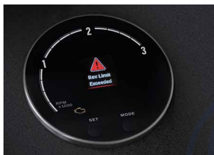
Configura alarmas locales y envías a otros dispositivos mediante NMEA 2000®
